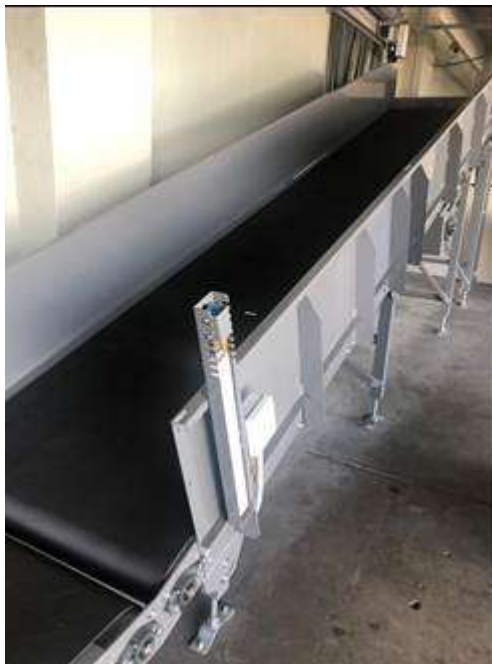
Figura 10.5. Banda transportadora sobre mesa inclinada (Instalación interna) a ubicar en líneas 1 y 2.
