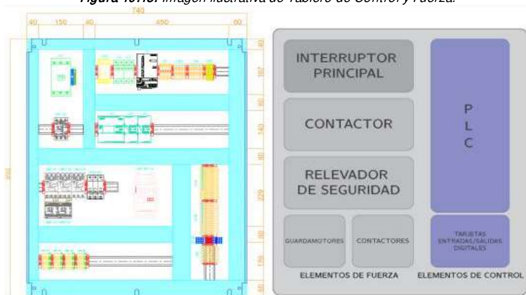
Figura 10.16. Imagen ilustrativa de distribución esquemática de Tablero de Control y Fuerza.
