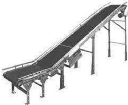
Figura 10.6. Banda transportadora sobre mesa inclinada (Instalación interna) a ubicar en líneas 2.
