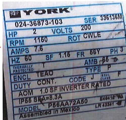
MOTORES ELECTRICOS DE 2 HP DE 200 VOLT A 1150/950RPM, 2 VELOCIDADES
