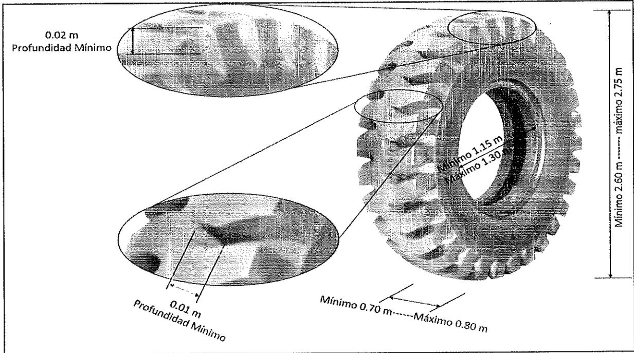
**DIAGRAMA DE AMORTIGUADOR (TIPO CELDA) DE HULE ENDURECIDO**
